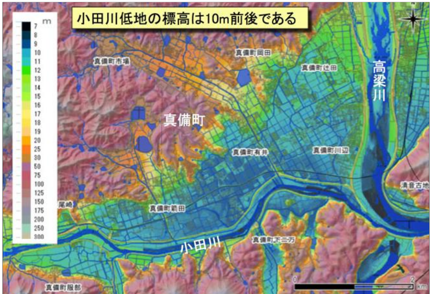
基盤地図情報(5mDEM)で作成した小田川低地の標高図
