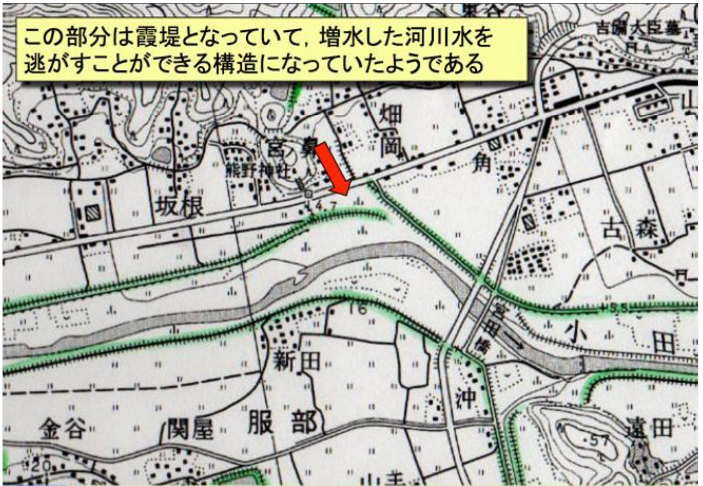
1989(平成元)年発行の地形図に示される霞堤と思われる箇所
