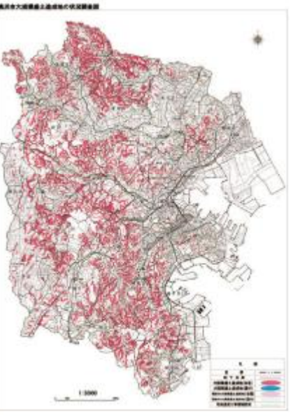
図2 横浜市（2010）による大規模宅地盛土造成地の状況調査図。市内における盛土の分布を的確に表現している
